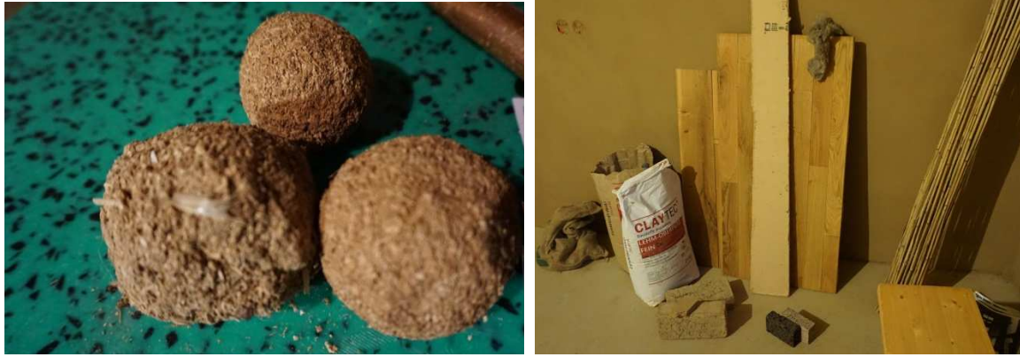
Abbildung 4: Verwendete Materialien: Lehm-Holzgemisch für die Innendämmung (links) sowie Schilfrohrmatte (Untergrund für Lehm-Holzgemisch) und Lehmputz (rechts). Das Lehm-Holzgemisch wird mit Wasser zu einer Art Brei verarbeitet, der auf die Schilfrohrmatte aufgetragen und eingearbeitet werden kann. Darüber wurde der Lehmputz aufgetragen, der im Hintergrund (Bild rechts) zu erkennen ist. Lehmputz eignet sich besonders gut für Bereich mit Versatz, da damit beispielsweise unebene Fensterlaibungen sehr gut ausgeglichen werden können. Insgesamt sorgt der Lehmputz für ein behagliches Raumklima.
